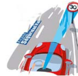
Sistema de Detección de Señales
