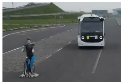
Adelantamiento de usuarios vulnerables en la vía
