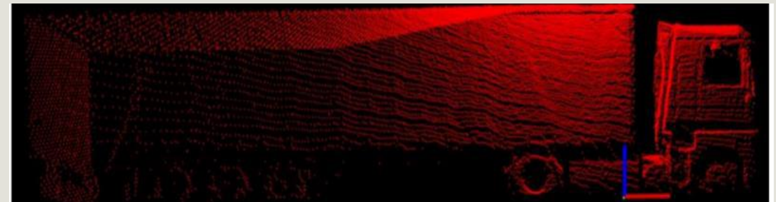
Detalle del lateral de un camión a su paso por un LiDAR con la nueva configuración
